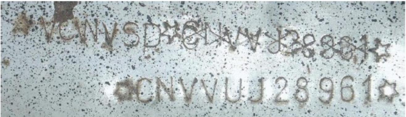
**3.1.2. N° Motore:** Nella stragrande maggioranza, salvo i più recenti, il tipo di motore è YORK4-AA o YORK4-AB; il n° del motore, se richiesto, si trova al lato Sx in direzione di marcia (Dx guardando dentro il cofano). In basso nella parte anteriore del blocco motore è in una parte spianata tra due fori filettati
